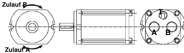
**Motor für zwei Drehrichtungen links und rechts (3 Anschlüsse)**
